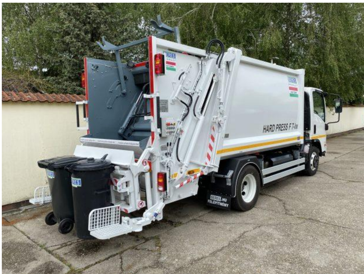
1. ábra Seres típusú felépítménnyel ellátott 17m 3 -es hulladékgyűjtő gépjármű
